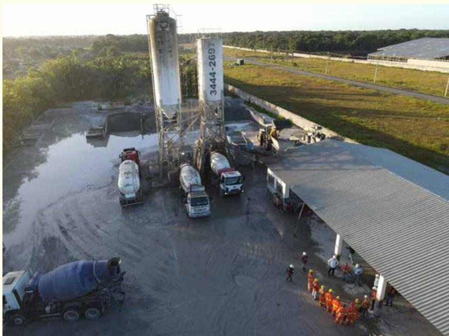
Figura 2. Carregamento das betoneiras na central de concreto (Polimix).
